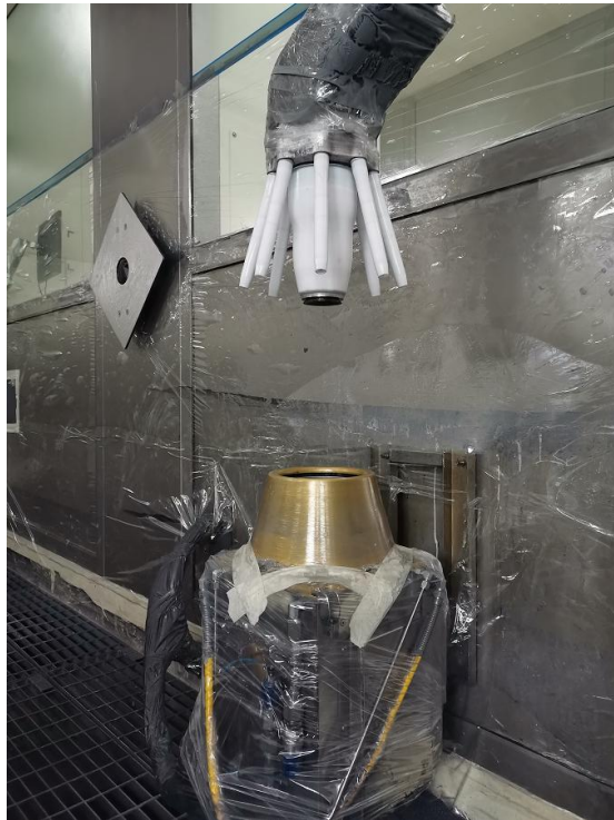
图 2-3 喷涂旋杯及清洗桶照片
