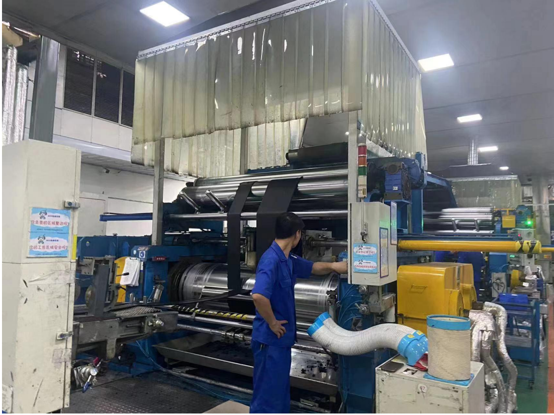
图 4-2 开炼机集气罩及软帘
