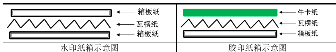
图 2-2 水印纸箱及胶印纸箱的示意图及实物照片
