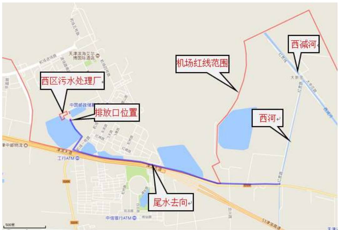
图 6 提标改造后剩余尾水经自然水体最终汇入西河图
