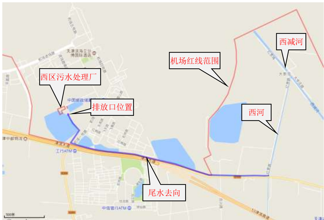
图 20 提标改造后剩余尾水经自然水体最终汇入西河图
