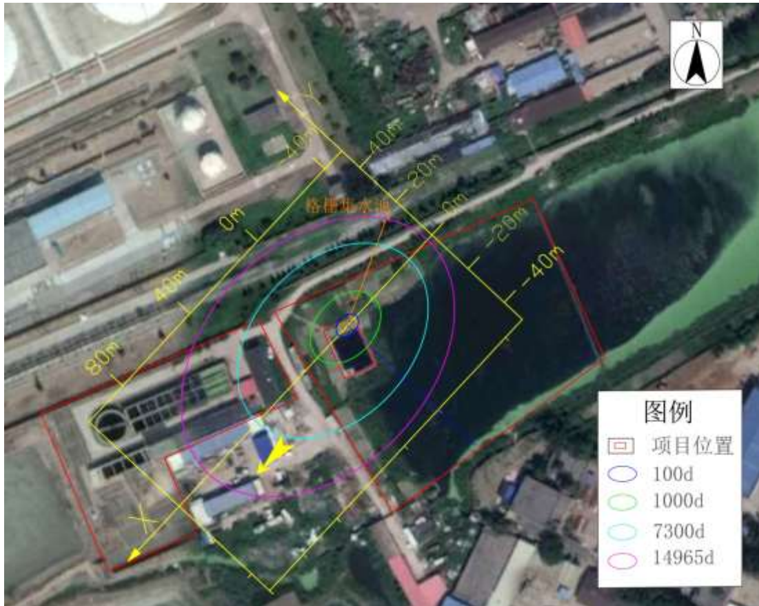
图 37 格栅集水池非正常状况泄漏后总氮影响(检出限)范围预测图
